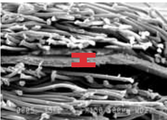
Capa funcional de láminas de varias capas estándar: 30 micrones
