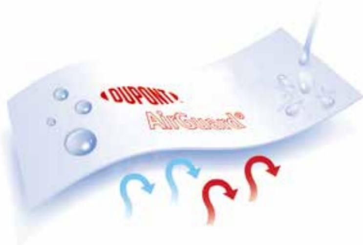
Con la instalación de una de las láminas de control del vapor DuPont™ AirGuard®, el aislamiento y la estructura de las paredes permanecen secos, lo que puede contribuir a la reducción del consumo de energía. Además de elegir la barrera de vapor correcta, es importante conseguir que la envolvente del edificio o sea estanca y hermética sellando los huecos entre las capas de aislante, las láminas de control del vapor y las láminas transpirables, y alrededor de ellas.
